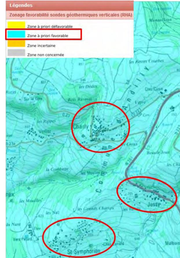
Zonage de la favorabilité pour des sondes géothermiques verticales - Source : Géothermie perspectives, BRGM
